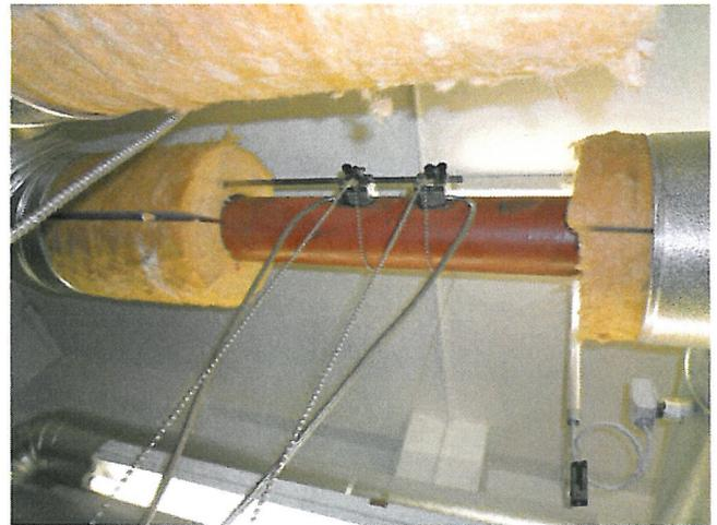
Während 48 Stunden wurde die erzeugte Wärmemenge im Minutentakt aufgezeichnet. Total wurden über 2'900 Einzelmessungen durchgeführt und die produzierte Wärmemenge ermittelt.
